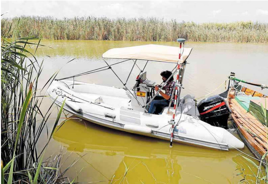
Trabajos de Batimetría en la Albufera para determinar la profundidad máxima y mínima del lago. JESÚS SIGNES
